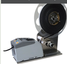
ZCUT*-9GRRP zmodyfikowany dla średnicy zewnętrznej 300
